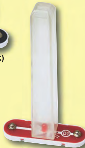
Světelná věž (LED doplněk) zapojena do D1
