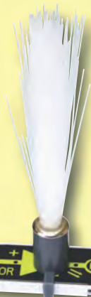
Optická strom (LED doplněk) zapojeno do D8
